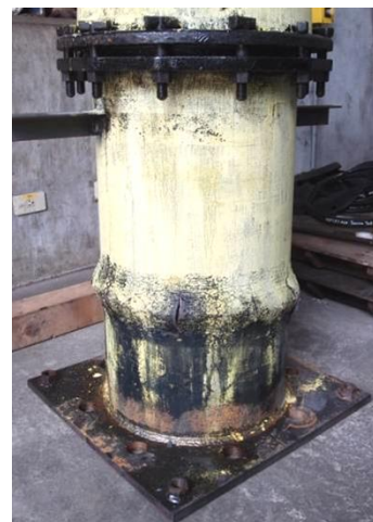
DIP(K)400-C1 ：試體變形至17.43mm時，挫屈處之東南側噴水
