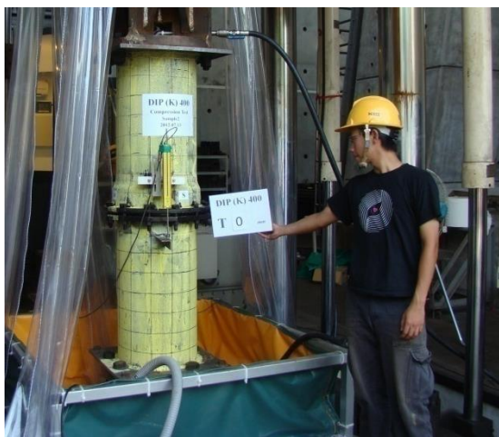
DIP(K)400-C2 ：試體變形至17.07mm時，挫屈處之西北側噴水
