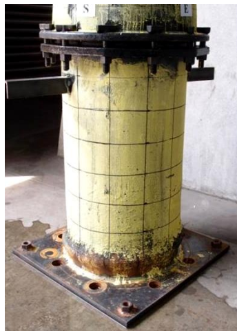
DIP(K)400-C2 ：試體變形至17.07mm時，挫屈處之西北側噴水
