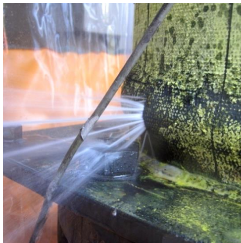
DIP(K)400-C2 ：試體變形至17.07mm時，挫屈處之西北側噴水
