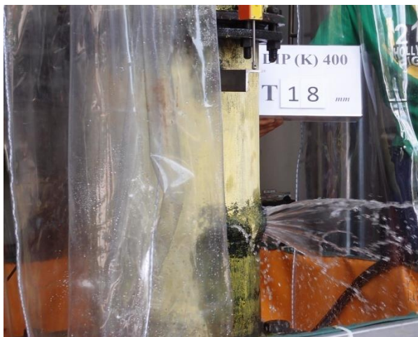
DIP(K)400-C1 ：試體變形至17.43mm時，挫屈處之東南側噴水
