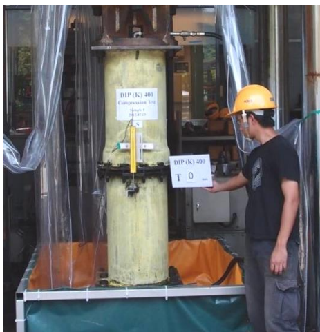
DIP(K)400-C1 ：試體變形至17.43mm時，挫屈處之東南側噴水
